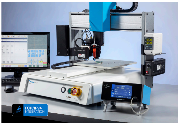
通过以太网使用NX协议可以从个人计算机或PLC进行编程。
