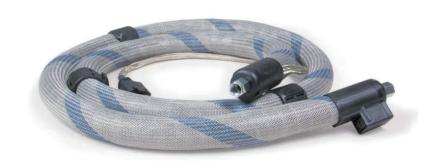
PureFlow 膠管可降低膠材及流體變質現象,例如碳化、固化、褪色和異味。由於使用過程中熱熔膠因變質所 產生的碳化物會在膠管內部逐漸堆積,導致大多數熱熔膠加熱管都出現了使用壽命縮短的問題。PureFlow 加 熱管透過維持熱熔膠材的穩定性和膠管內部清潔,可使膠管平均使用壽命延長一倍以上。此外,RediFlex Ⅱ 支架可改善配線和懸掛,進一步延長膠管的使用壽命。膠管內部的聚醯胺絕緣層可維持穩定的溫度,進而提高 加熱效率和熱熔膠流量。
