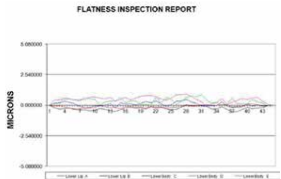
固定塗唇狹縫式塗頭的平整度檢查結果
